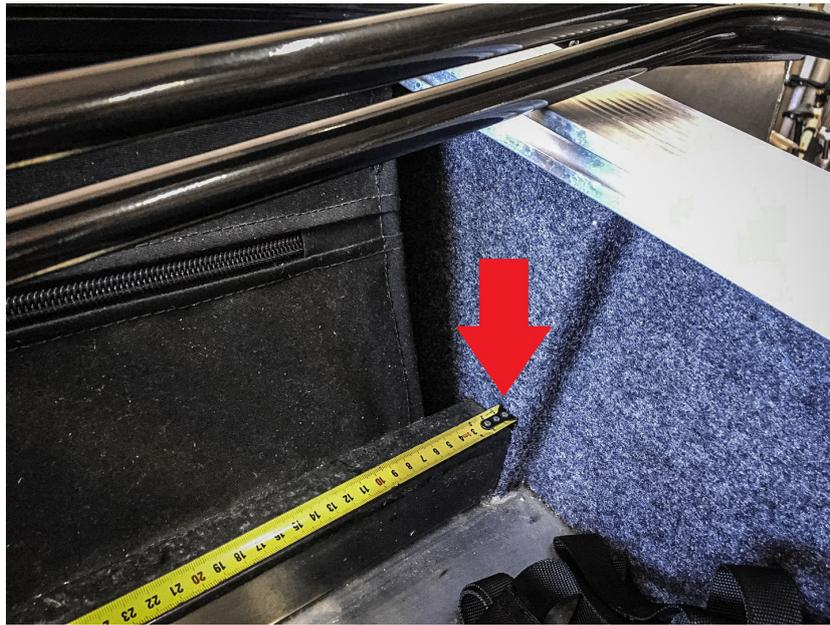
2) Установите кронштейн крепления дуг к корпусу лодки на расстоянии 1155 мм (по центру кронштейна)
